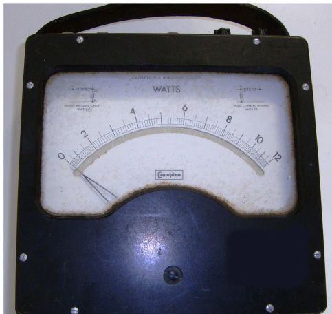
(a) Medidor analógico. Pela indicação da unidade watt, nota-se que é um medidor de potência.
