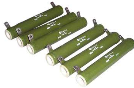
(b) Resistor para circuitos de elevada potência. Possuem em torno de 30 cm de comprimento e são cilindros ocos para facilitar a circulação de ar e evitar aquecimento excessivo.
