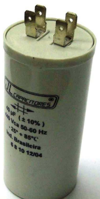
(a) Capacitor de 40 \mu\text{F} para tensão eficaz de até 400 V e frequências de 50 ou 60 Hz.
