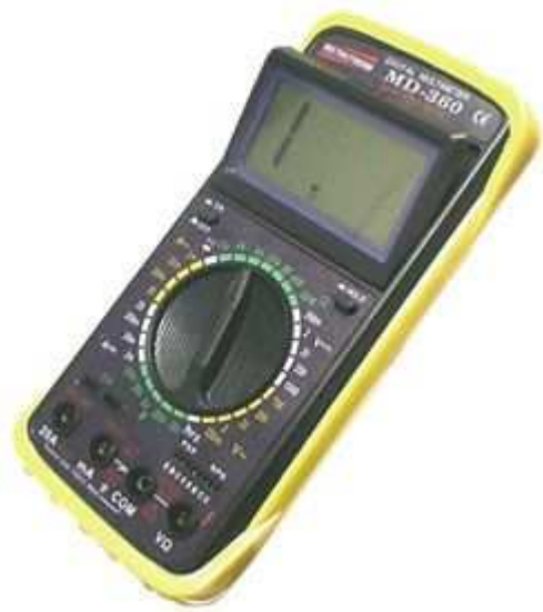
(b) Medidor digital. É possível medir várias grandezas elétricas com este medidor e este tipo é chamado de multímetro.
